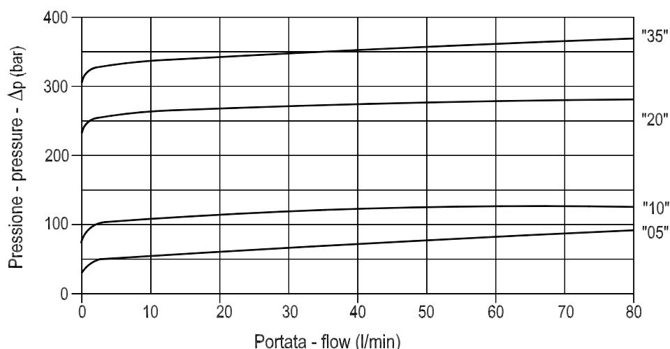
**Valvola di regolazione pressione con cono guidato ad azione diretta**
